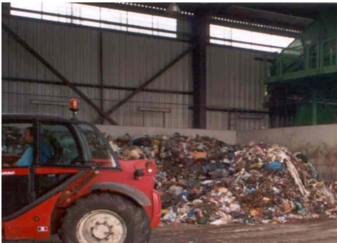
Stacja rozładunkowa odpadów w ZUOK (źródło: LEMTECH).
